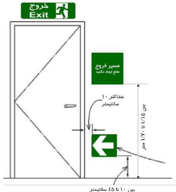
شکل ۱۵-۱- فواصل نصب تابلو روی دیوار
