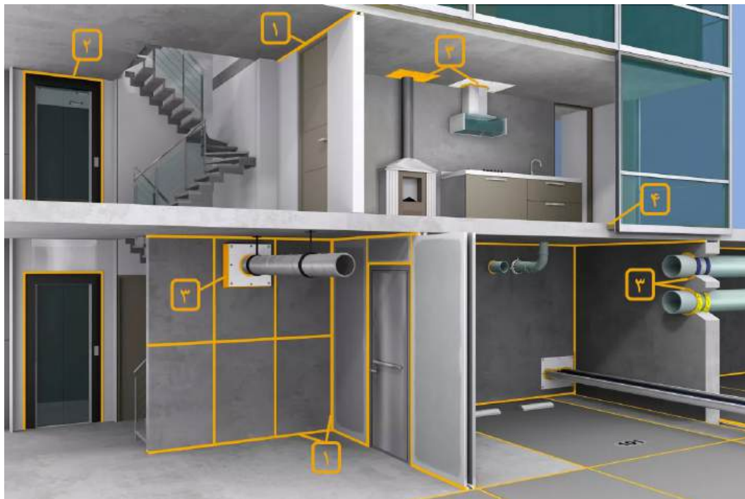
شکل ۱- ۱۷- مثال‌هایی از درزبندی آتش
