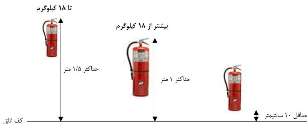
شکل ۹-۶- ارتفاع نصب خاموش‌کننده دستی از کف
